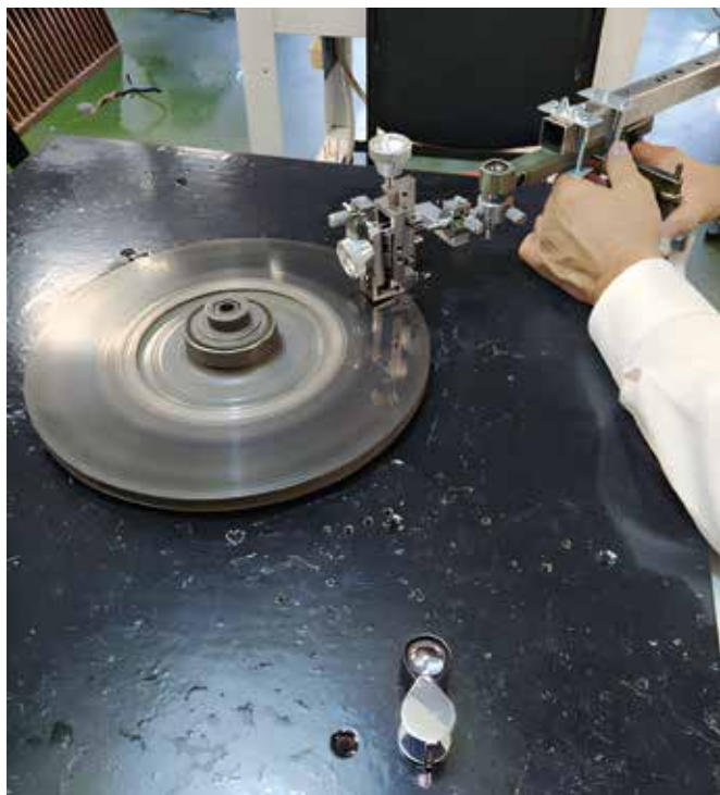
Рис. 2. Ручная полировка пластины с применением оригинального держателя
