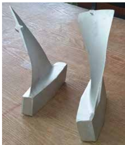
Рис. 6. Штамповка имитатора лопатки из алюминиевого сплава Al – 5,3% Cu – 0,8% Mg – 0,5% Ag – 0,3% Mn – 0,15% Zr [8]
