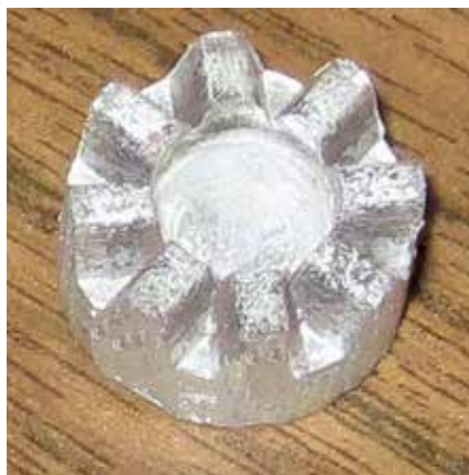
Рис. 7. Штамповка зубчатой полумуфты из алюминиевого сплава АМг6 [9]
