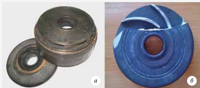
Рис. 5. Штамповки из сплава Д16Т деталей нефтяного насоса [7]: а – штамповки деталей «Аппарат направляющий» и «Колесо рабочее», б – разрез штамповки детали «Колесо рабочее»
