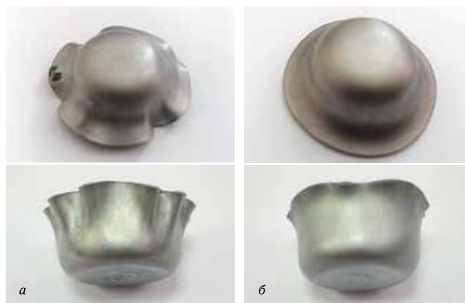
Рис. 7. Металлические заготовки после вытяжки полимерным инструментом из PLA без прижима (а) и с прижимом (б)
