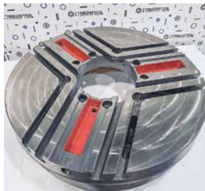
Рис. 5. Корпус планшайбы колесотокарных станков мод. UBB-112 и их модификаций
