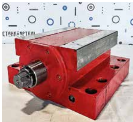
Рис. 4. Гидроцилиндр поводка зажима колесной пары в сборе для колесотокарных станков мод. РТ905; ход штока – 59 мм, рабочее давление – 30 бар
