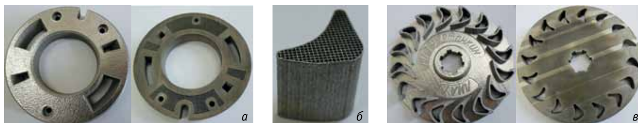
Рис. 6. Детали, полученные на установке ПТК-ПС: «Вставка» (а), экспериментальная лопатка с сетчатой структурой (б), «Турбина» (в)
