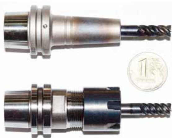
Рис. 4. Патроны для закрепления концевых фрез с цилиндрическим хвостовиком диаметром 6 мм: термopатрон для закрепления способом термических деформаций (вверху); цанговый патрон (внизу)
