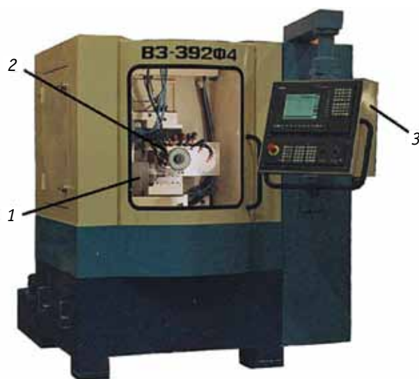
Рис. 8. Шлифовально-заточной станок ВЗ-392Ф4: 1 — бабка изделия; 2 — бабка инструмента; 3 — панель управления
