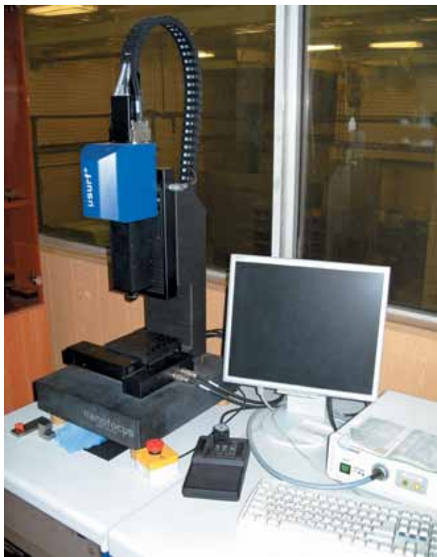
Рис. 4. Сканирующий микроскоп « \mu Surf» фирмы NanoFocus AG
