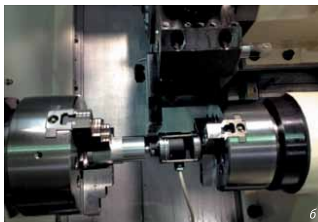
Рис. 1. Установка измерительных датчиков фазохронометрической системы на станках:
