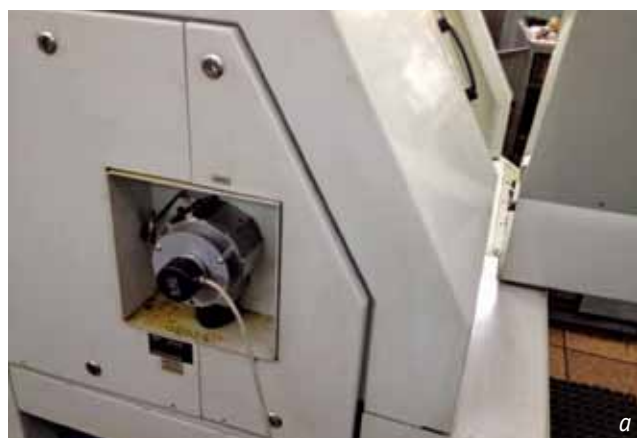
Рис. 1. Установка измерительных датчиков фазохронометрической системы на станках:
