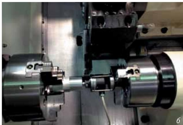
**Рис. 1.** Установка измерительных датчиков фазохронометрической системы на станках:
