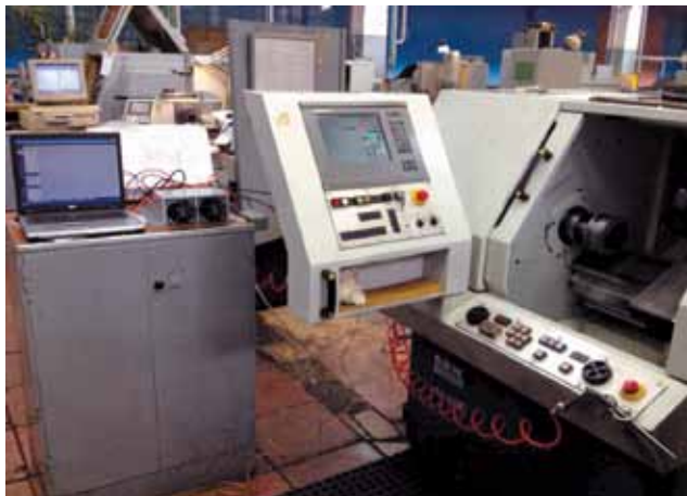
Рис. 2. Общий вид измерительной фазохронометрической системы для станка G.D.W. 240 CNC
