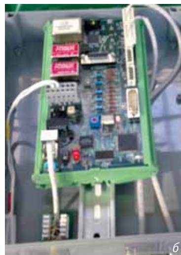
Рис. 7. Общий вид информационно-измерительного комплекса на базе фазохронометрического метода: а — блок обработки информации; б — измерительный блок
