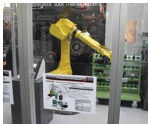
Робот, производящий замену инструмента в магазине станка
