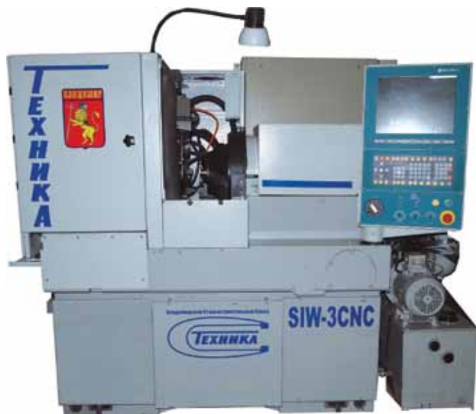
Рис. 4. Станок специальный для шлифовки колец подшипников модели SIW-3
