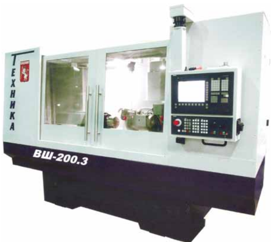
Рис. 8. Многошпиндельный станок модели ВШ
