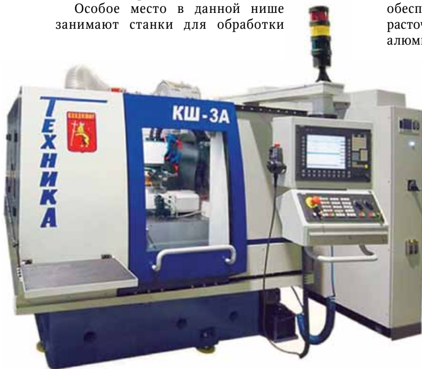
Рис. 10. Станок для обработки колец из карбида кремния
