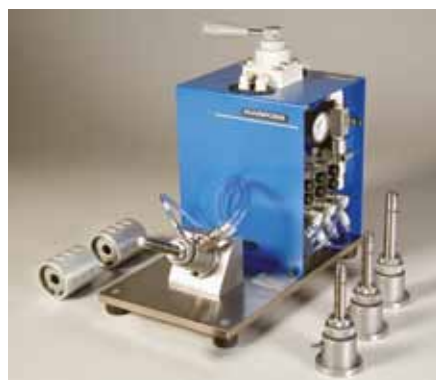
Рис. 11. Прибор сопряженного шлифования Marposs S.p.A. (пневматический стенд для контроля внутреннего диаметра, измерительные головки Unimar S26 с арретированием и электронный блок P7 sys)
