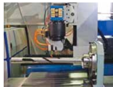
Рис. 12. Комплекс лазерного термоупрочнения модели АЛТКУ-3
