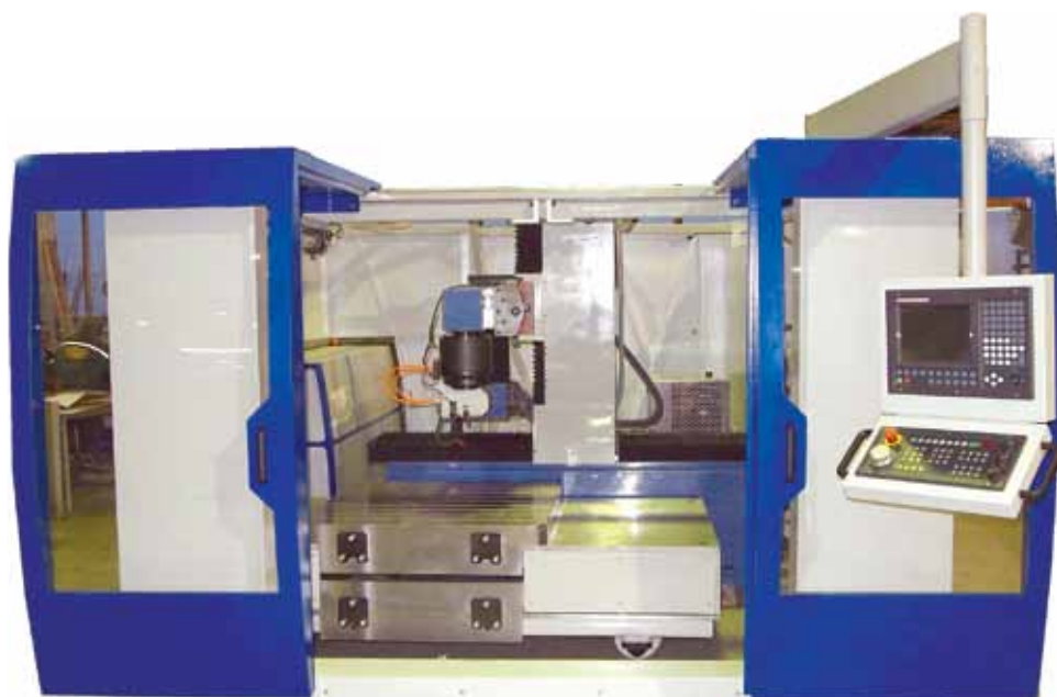
Рис. 12. Комплекс лазерного термоупрочнения модели АЛТКУ-3
