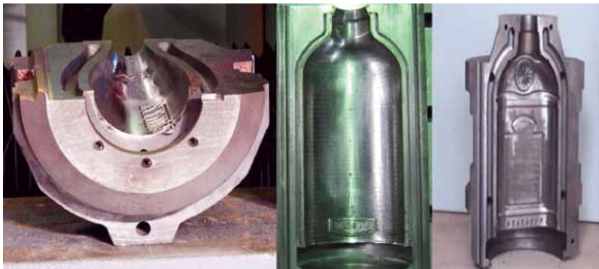
Рис. 13. Примеры лазерного упрочнения кромок и формообразующих поверхностей пресс-форм. Чугун низколегированный. Твердость упрочнения 52–56 HRC. Глубина упрочнения 1,1–1,3 мм
