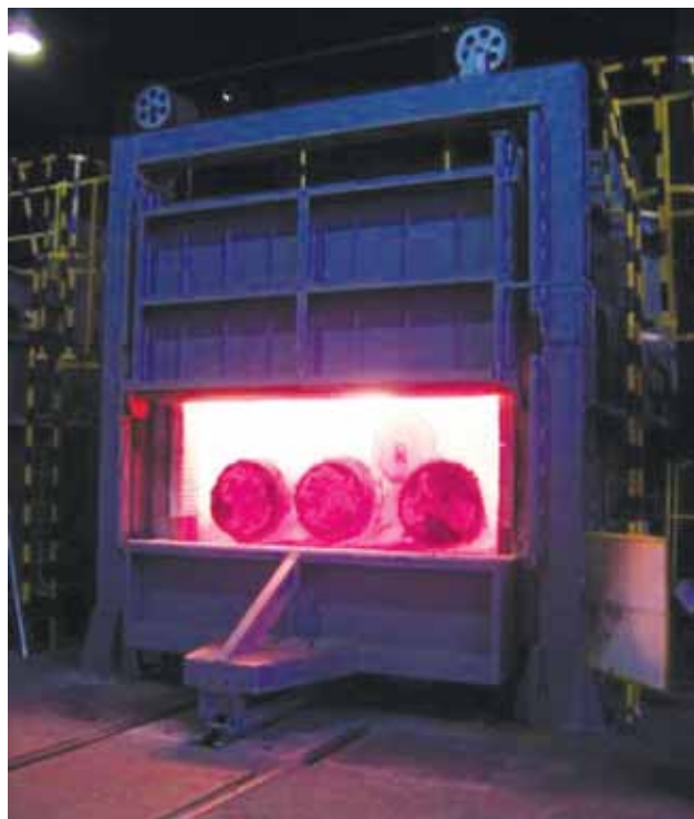
Рис. 3. Печь с выкатным подом 3,4 * 2 * 5,7 м с предварительным нагревом воздуха
