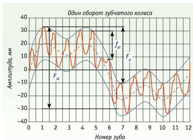
Рис. 2. Пример графической интерпретации результатов автоматизированного контроля на межцентромере НИИК-1020-400
