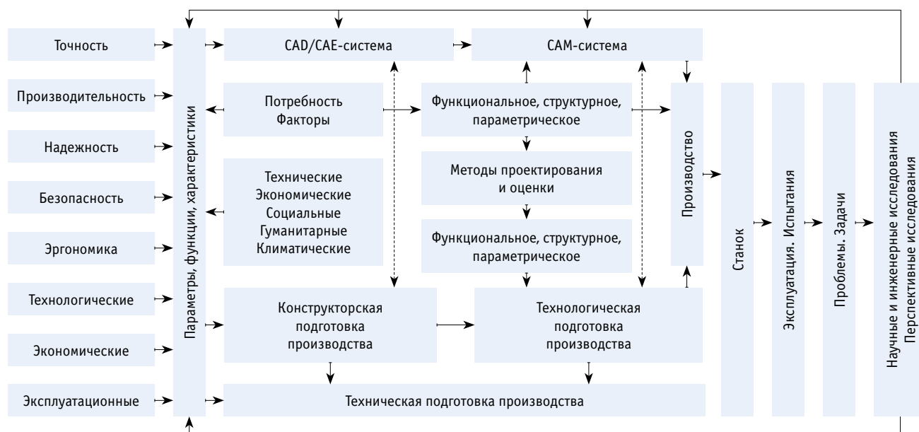
Рис. 3. Организационно-технологическая схема жизненного цикла станков
