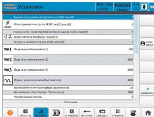
Рис. 5. Экран параметрического программирования ПЛК
