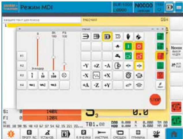
Рис. 6. Экран виртуального пульта оператора
