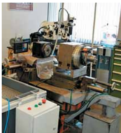
Рис. 2. Специальный ультрапрецизионный станд для фрезерования летучим резцом
