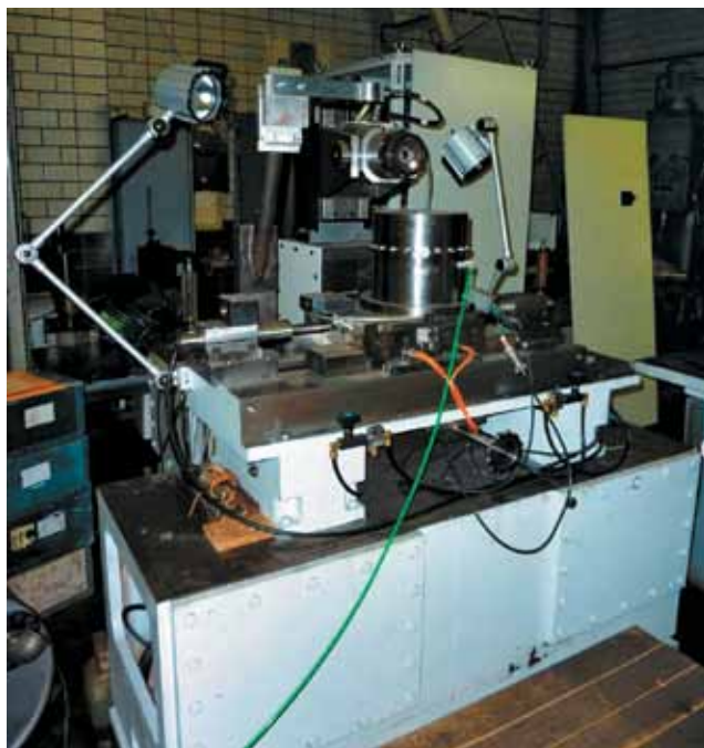
Рис. 1. Специальный ультрапрецизионный станд для шлифования
