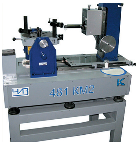
Рис. 1. Двухкоординатный измерительный прибор НИИК-481КМ2
