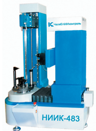
Рис. 4. Четырехкоординатная измерительная система НИИК-483
