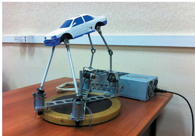
Рис. 6. Тренажер для обучения водителей и испытания подвески автомобиля
