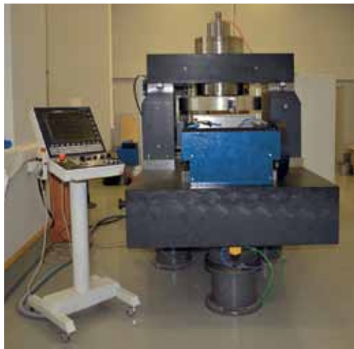
Рис. 3. Ультрапрецизионный фрезерный обрабатывающий станок модели КДП 450 Ф1
