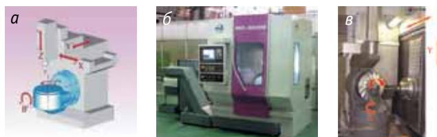
Рис. 1. Схемы расположения управляемых координат в 5-координатных станках группы 5КСТ 2,0 : а – схема компоновки станка модели МС 300, б – общий вид станка модели МС 300, в – станок модели FSP 300X ф. Moore Tool Company, Inc. с поворотным столом типа «люлька»
