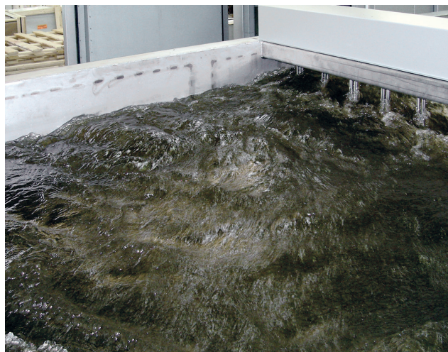
Рис. 2. Циркуляция охлаждающей среды в закалочном устройстве
