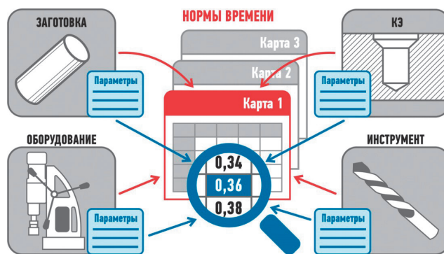
Рис. 12. СТН-нормирование трудовых затрат на основе укрупненных общемашиностроительных норм времени
