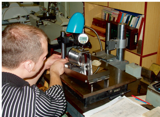
Рис. 2. Измерение внутреннего диаметра трапецидальной резьбы
