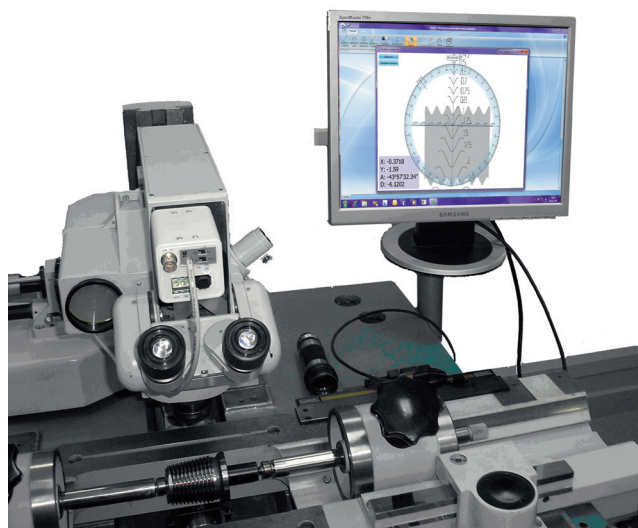
Рис. 6. Контроль конического резьбового калибра-пробки с помощью измерительной системы НИИК-890 «ОптИС»
