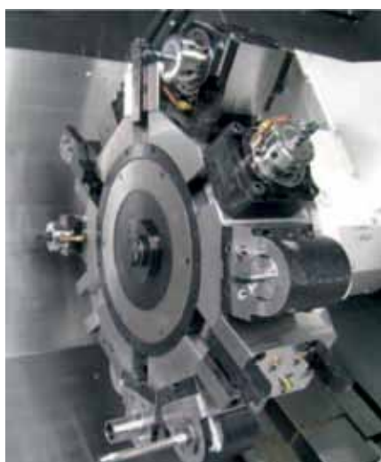
Рис. 5. Стандартная 12-станционная головка
