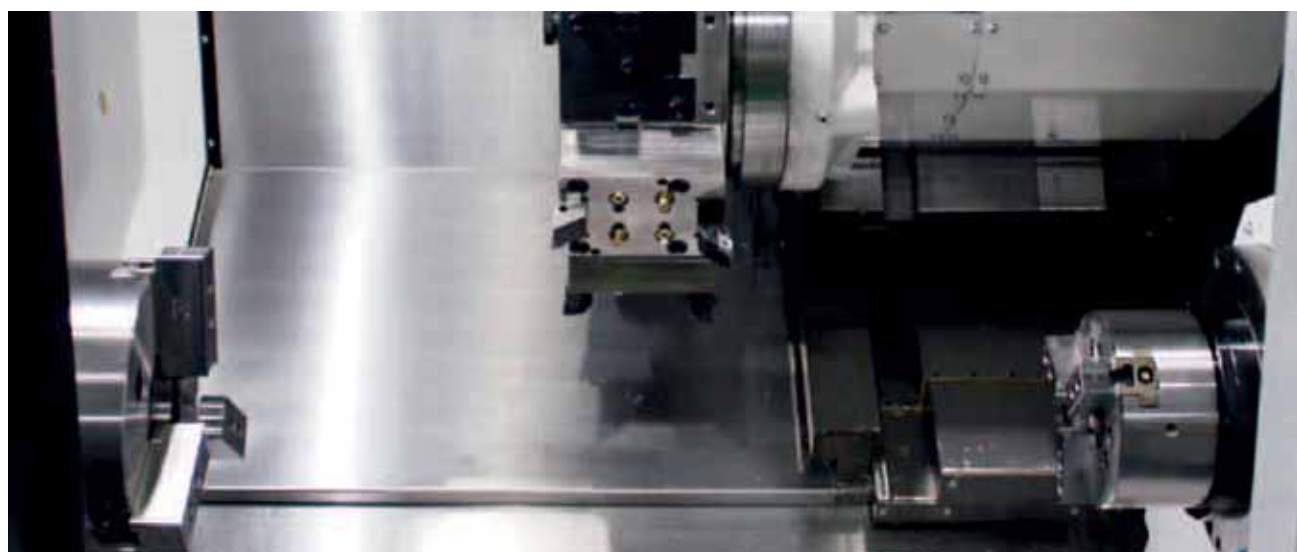
Рис. 15. Стандартный/максимальный диаметр обточки 280/370 (T12)
