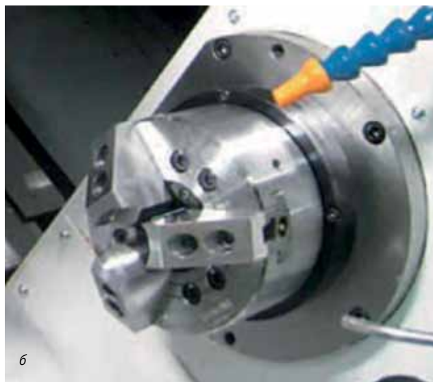
Рис. 8. Шпиндели обрабатывающих центров серии «КТС»: а – главный мотор-шпиндель, б – противошпиндель
