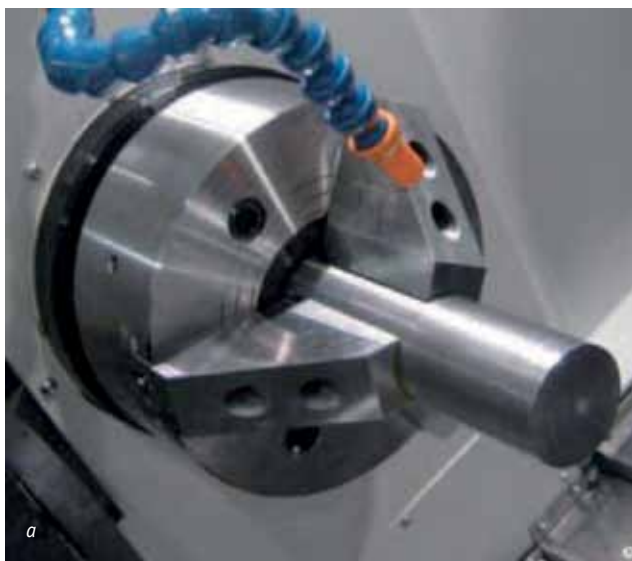
Рис. 8. Шпиндели обрабатывающих центров серии «КТС»: а – главный мотор-шпиндель, б – противошпиндель
