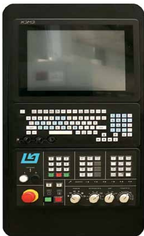
Рис. 1. Система управления для станков с ЧПУ, разработанная ОАО «КЭМЗ» и компанией «Техникон»
