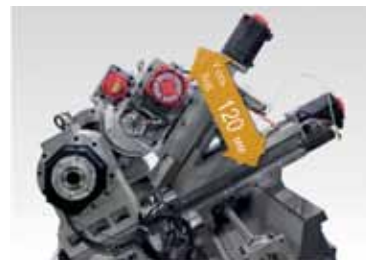
Рис. 4. Ход по оси Y 120 мм
