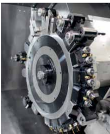
Рис. 6. Опциональная 20-станционная головка
