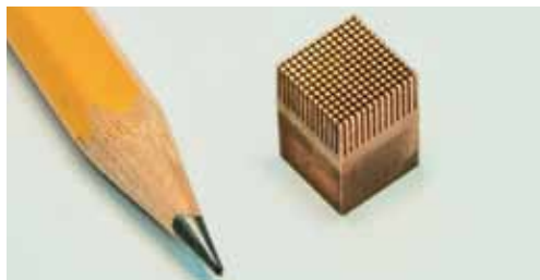
Рис. 1. Микроэрозионная обработка на станке АРТА 123 ПРО. Изготовление электрода из эльконайта (вольфрамо-медный сплав) для последующей прошивки титановых пластин
