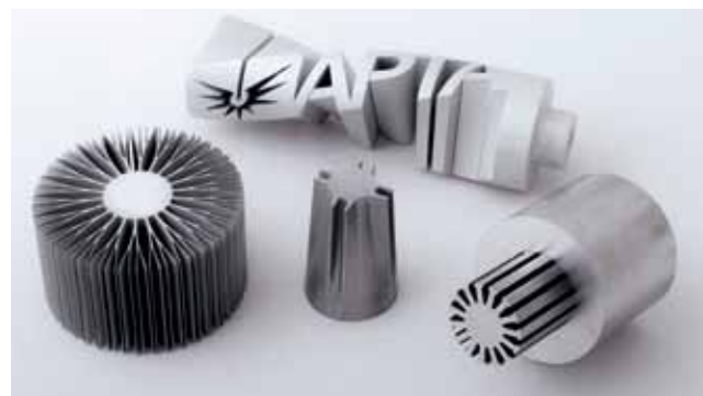
Рис. 6. Электроэрозионная проволочно-вырезная 2-, 3- и 4-координатная обработка
