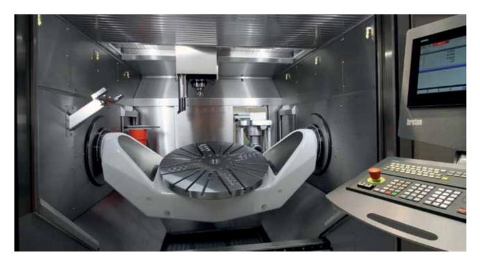
Вместе с тем, на новом Ultrix 1200 Evo станина стала намного жестче. Это видно по количеству опор, на которые устанавливается станок. Если раньше их было семь, то теперь только три, несмотря на возросшие размеры. Такой подход упрощает подготовку фундамента и сокращает время выставления станка как при сборке, так и в процессе эксплуатации.
