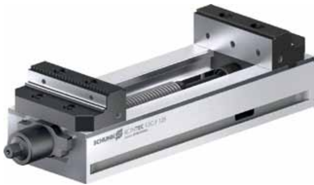
Рис. 3. Быстрозажимные тиски KONTec KSC-F: идеально подходят как для индивидуального применения, так и для использования в паллетных системах. Благодаря модульной системе, интерфейсу VERO-S и быстрому зажиму поворотом рукоятки на 160° тиски перенастраиваются под новые задачи за минимальный промежуток времени
