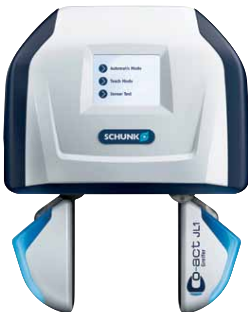
Рис. 5. Победитель премии Hermes Award 2017: а – захват SCHUNK серии Co-act JL1 – первый в мире интеллектуальный захватывающий модуль для робототехники, который напрямую взаимодействует и общается с людьми; б – сенсорная система, встроенная в JL1, регистрирует присутствие человека и позволяет принимать ситуационно-зависимые решения без какого-либо контакта человека и робота
