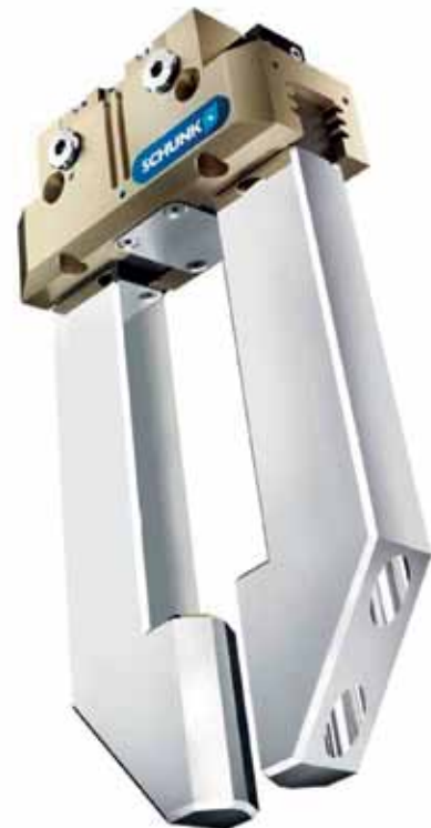
Рис. 1. Захват PGN-plus-P: большая грузоподъемность и моментные характеристики обеспечивается благодаря усиленной тройной направляющей и увеличенным диаметром приводного поршня. Широкая номенклатура датчиков контроля положения захвата и аксессуаров
