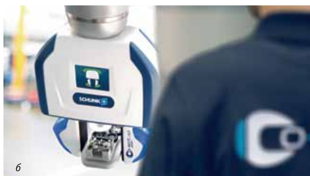
Рис. 5. Победитель премии Hermes Award 2017: а – захват SCHUNK серии Co-act JL1 – первый в мире интеллектуальный захватывающий модуль для робототехники, который напрямую взаимодействует и общается с людьми; б – сенсорная система, встроенная в JL1, регистрирует присутствие человека и позволяет принимать ситуационно-зависимые решения без какого-либо контакта человека и робота
