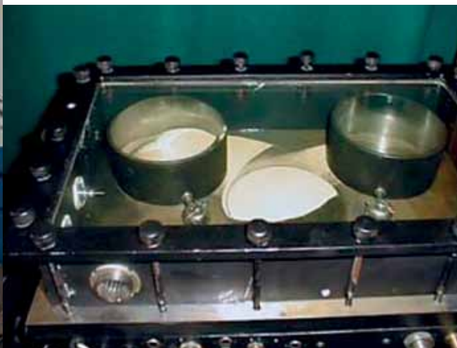
Камера синтеза с двумя бункерами для порошков
