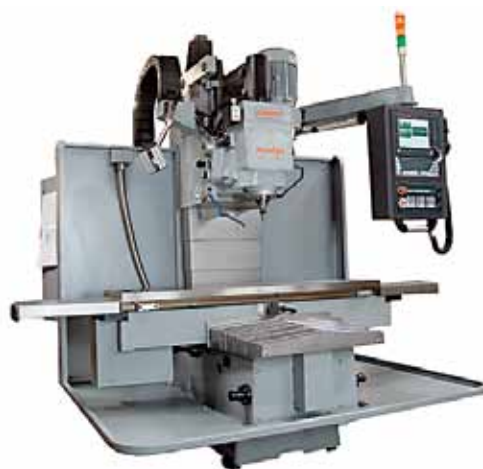
Рис. 13. Фрезерный станок открытого типа (серия 61Ф4ПЗ) с УЧПУ NC-310 «Балт-Систем», созданный на производственной базе ООО НПП «МЕАТЭК»
