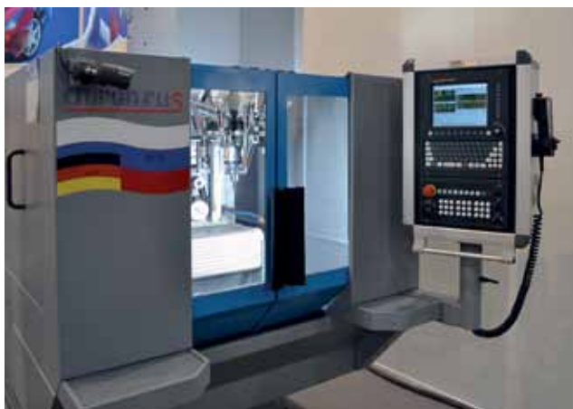
Рис. 10. Фрезерный станок производства ООО «Широн Рус» с УЧПУ NC-310 «Балт-Систем»
