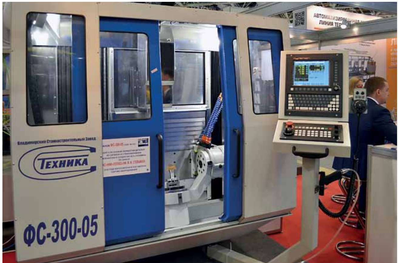
Рис. 8. 5-осевой специальный фрезерный обрабатывающий центр FC-300-05 производства ООО ВСЗ «Техника» с УЧПУ NC-310 «Балт-Систем»
