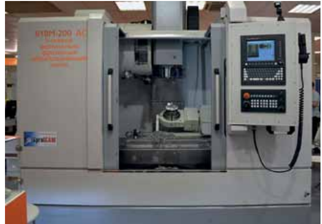
Рис. 9. 5-осевой вертикально-фрезерный обрабатывающий центр 61VM-200 с УЧПУ NC-310, создан на производственной базе ООО НПП «МЕАТЭК»
