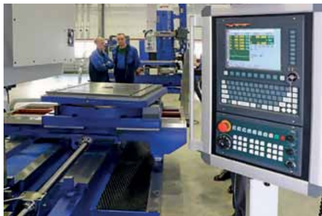
Рис. 14. Горизонтально-расточной станок ГРС-100А с УЧПУ NC-310 «Балт-Систем» (усовершенствованная версия горизонтально-расточного станка, выпускаемого компанией «TOS Varnsdorf» уже много лет). Произведен АО «ГРС-Урал»
