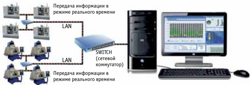
Персональный компьютер с программой мониторинга оборудования
