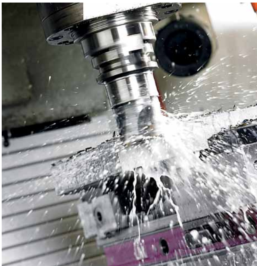
Рис. 1. Эффективная защита от СОЖ – неотъемлемое требование к уплотнениям современных станков
