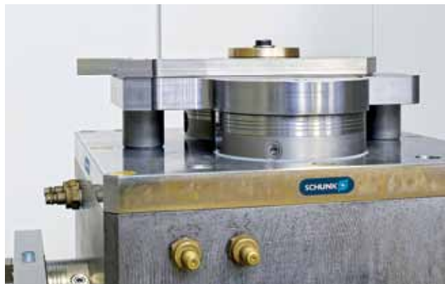
Рис. 7. Быстросменная паллетная система VERO-S: головка монтажной стойки также оснащена двумя зажимными модулями SCHUNK VERO-S. В результате этого, монтажные стойки можно использовать с пяти сторон
