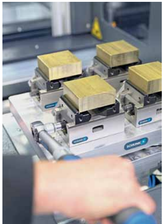
Рис. 3. Станция загрузки: для достижения полной автоматизации тиски SCHUNK KONTec KSC установлены на паллетах, благодаря повороту рукоятки быстрого зажима на 160° паллеты всего за пару секунд становятся доступны для работы, который переместит их на хранение на внешнюю станцию загрузки
