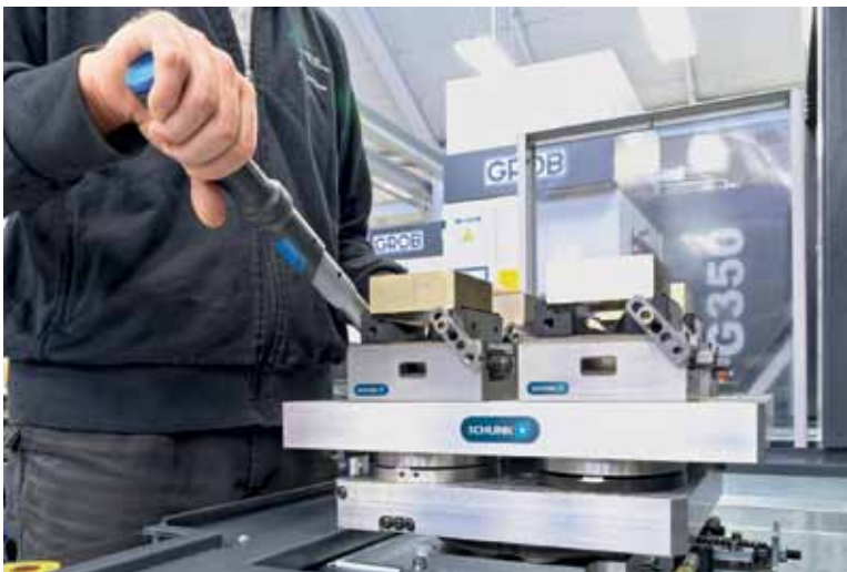
Рис. 3. Станция загрузки: для достижения полной автоматизации тиски SCHUNK KONTec KSC установлены на паллетах, благодаря повороту рукоятки быстрого зажима на 160° паллеты всего за пару секунд становятся доступны для работы, который переместит их на хранение на внешнюю станцию загрузки
