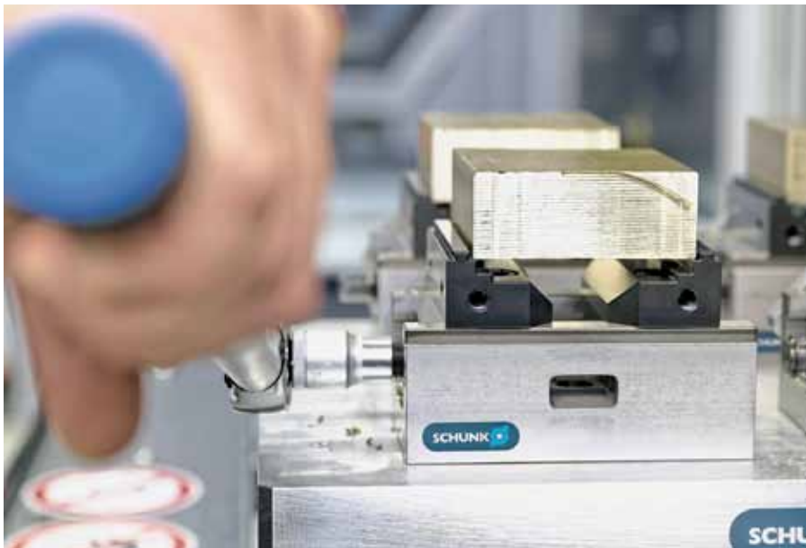
Рис. 1. Штампующие губки: поворот на 160° с помощью динамометрического ключа – это все, что необходимо для автоматического зажима заготовки в тисках SCHUNK KONTEC KSC без предварительной штамповки обработанных деталей, отнимающей дополнительное время
