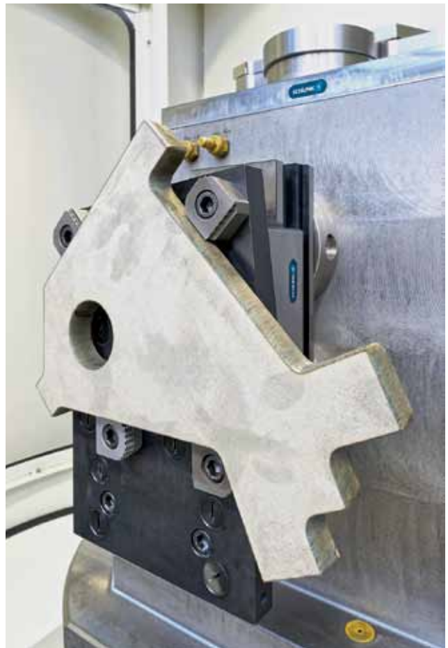
Рис. 6. Зажимной элемент KONTEC: в данном решении применение маятниковой плиты, состоящей из стандартных элементов SCHUNK, гарантирует низкий уровень деформации вследствие недеформирующего зажима. Благодаря превосходным результатам, последующая шлифовка не требуется
