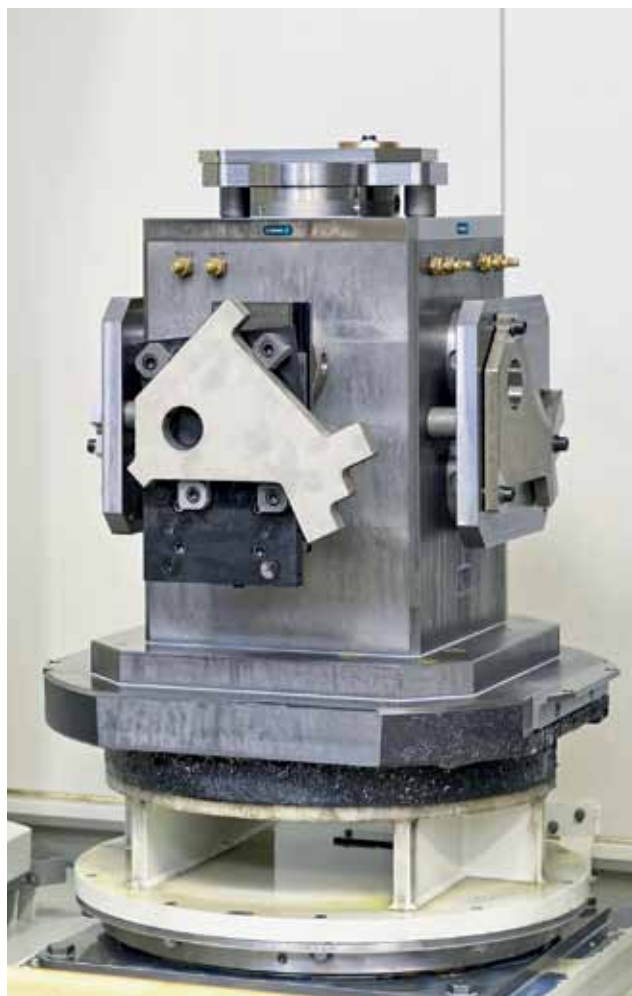
Рис. 4. Монтажная стойка: для обеспечения высокого удерживающего усилия требуются только две быстросменные паллетные системы SCHUNK VERO-S, которые гарантируют точный и безвибрационный зажим стандартизированных тисков и зажимных приспособлений производства компании SCHUNK, монтажные стойки оснащены быстросменными модулями на пяти сторонах, что обеспечивает быстроту установки
