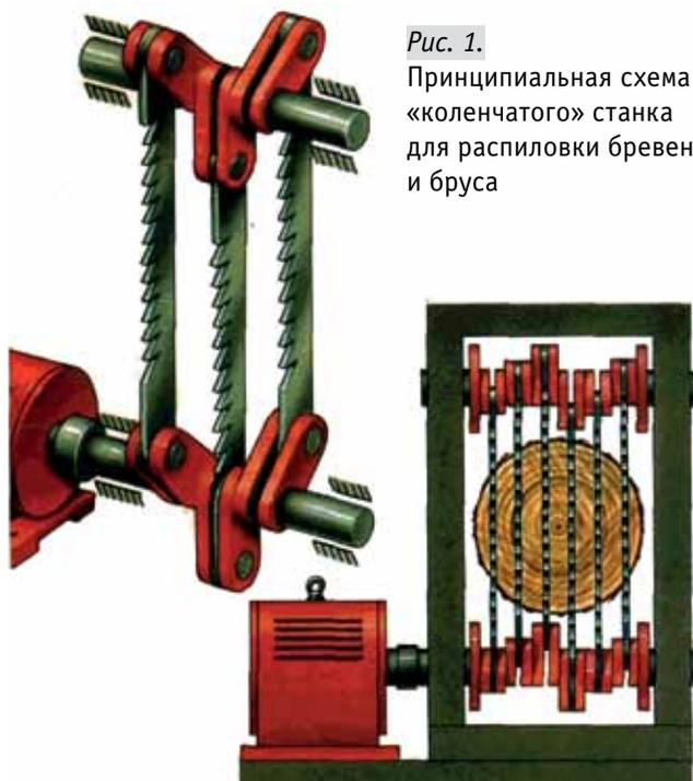
Рис. 1. Принципиальная схема «коленчатого» станка для распиловки бревен и бруса
