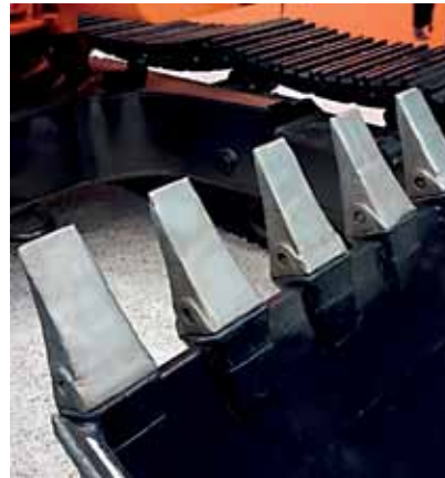
Рис. 6. Ковш экскаватора с восстановленными лазерной наплавкой зубьями
