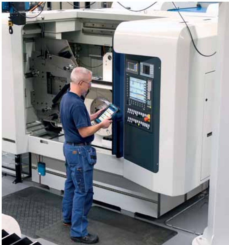
Рис. 1. Мониторинг состояния станочного оборудования с помощью SKF IMx-8
