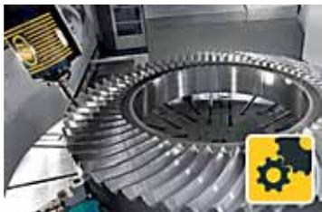
Рис. 13. Коническое зубчатое колесо с дуговым зубом, изготовленное на расточном станке SPiRiT
