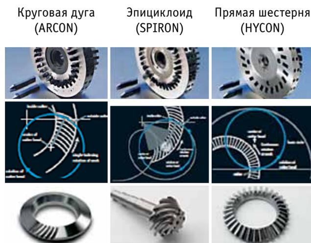
Рис. 17. Технология точения конических зубчатых колес Oerlikon
