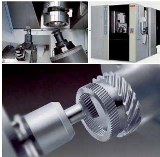
Рис. 15. Производство зубчатых колес по технологии зуботочения
