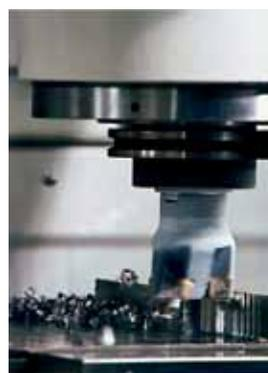
Рис. 18. Криогенная обработка с использованием подачи через шпиндель
