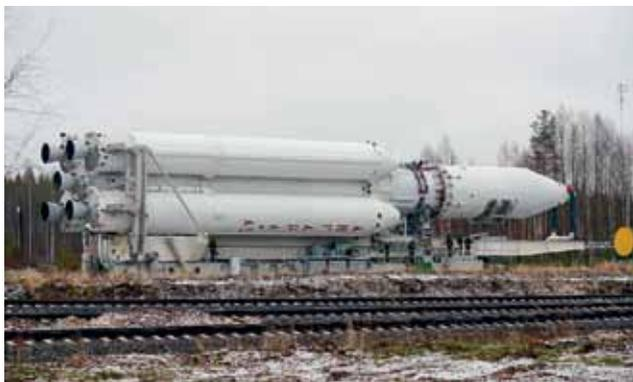
Рис. 14. Корпус ступени ракеты «АНГАРА», сваренный сваркой трением на расточном станке SPiRiT с подвижной колонной по технологии фирмы FPT
