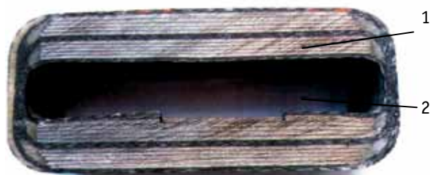
Рис. 1. Конструкция намотки: 1 – пакет усиления; 2 – свободное пространство
