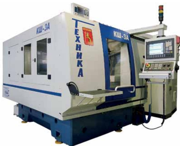
Рис. 3. Универсальный круглошлифовальный станок для обработки карбида кремния
