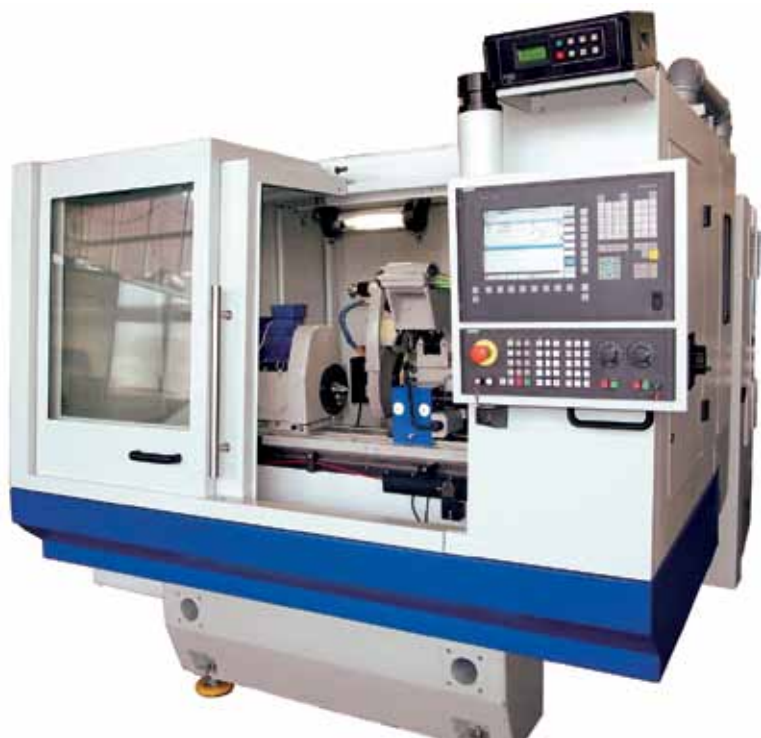
Рис. 2. Универсальный круглошлифовальный станок с УЧПУ
