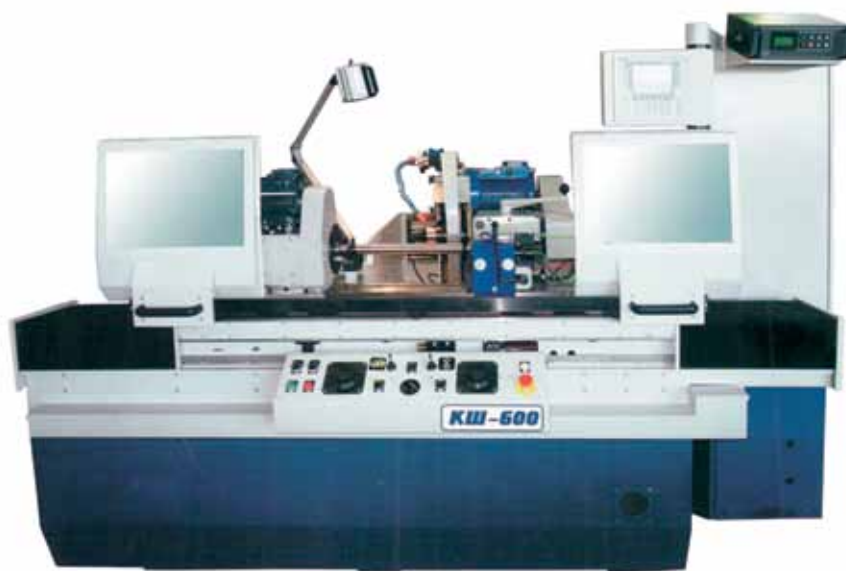
Рис. 1. Универсальный круглошлифовальный станок с командоконтроллером
