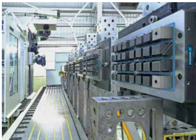
Рис. 2. Общий вид: магнитные модули SCHUNK MAGNOS располагаются на столе станка сбоку, что означает, что продольно-фрезерный расточный многоцелевой станок SORALUCE можно в любое время использовать для других операций по обработке
