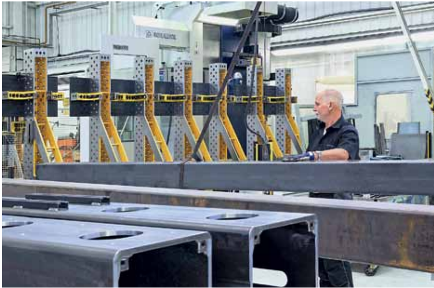
Рис. 9. Портальные опоры: при использовании в компании BLEICHERT магнитное зажимное решение от SCHUNK мгновенно окупилось благодаря эффективности
