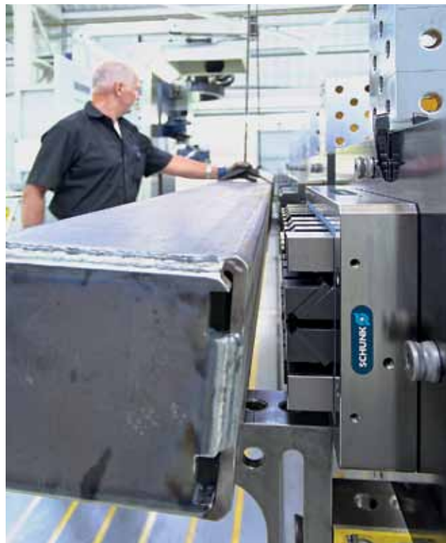
Рис. 5. Дополнительная опора: перед тем, как выполнить зажим деталей, Армин Рит помещает детали на два вспомогательных стола. Они крепятся с помощью болтов и складываются вниз после того, как выполнен надежный зажим деталей
