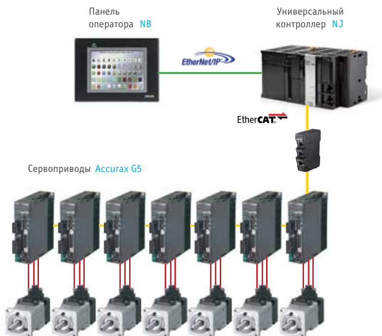
Рис. 4. Конфигурация системы управления роботом ARKODIM
