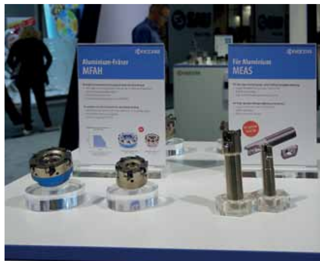
Специализированные фрезы для обработки алюминиевых сплавов. Серия MFH – для чистовой и финишной обработки. Простой механизм регулировки торцевого биения позволяет получить зеркальную поверхность
