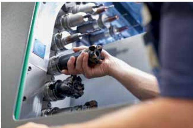
Рис. 5. Инструментальный магазин станка может включать до 80 позиций установки инструмента. Таким образом, заказчик может подготовить VMC MT для обработки различных деталей и установить в магазин инструменты-дублиеры
