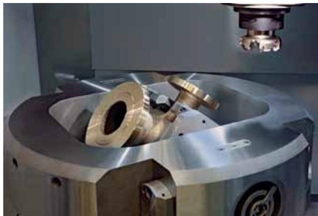
Рис. 2. Поворотные индексные патроны дополнительно повышают производственную гибкость станка
