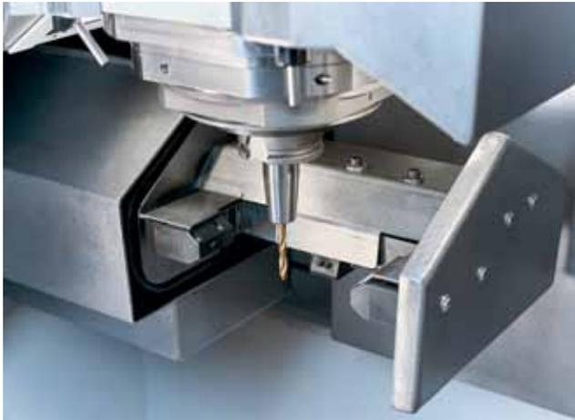
Рис. 4. Инструменты проверяются с помощью лазерного измерительного мостика
