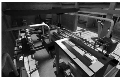
Рис. 2. Виртуальная модель цеха стального и чугунного литья мощностью 5 000 т/г (формовочно-заливочный участок)
