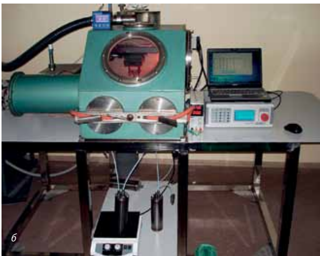
Рис. 2. Схема эксперимента (а) и фотография установки вакуумного аэрозольного осаждения (б)
