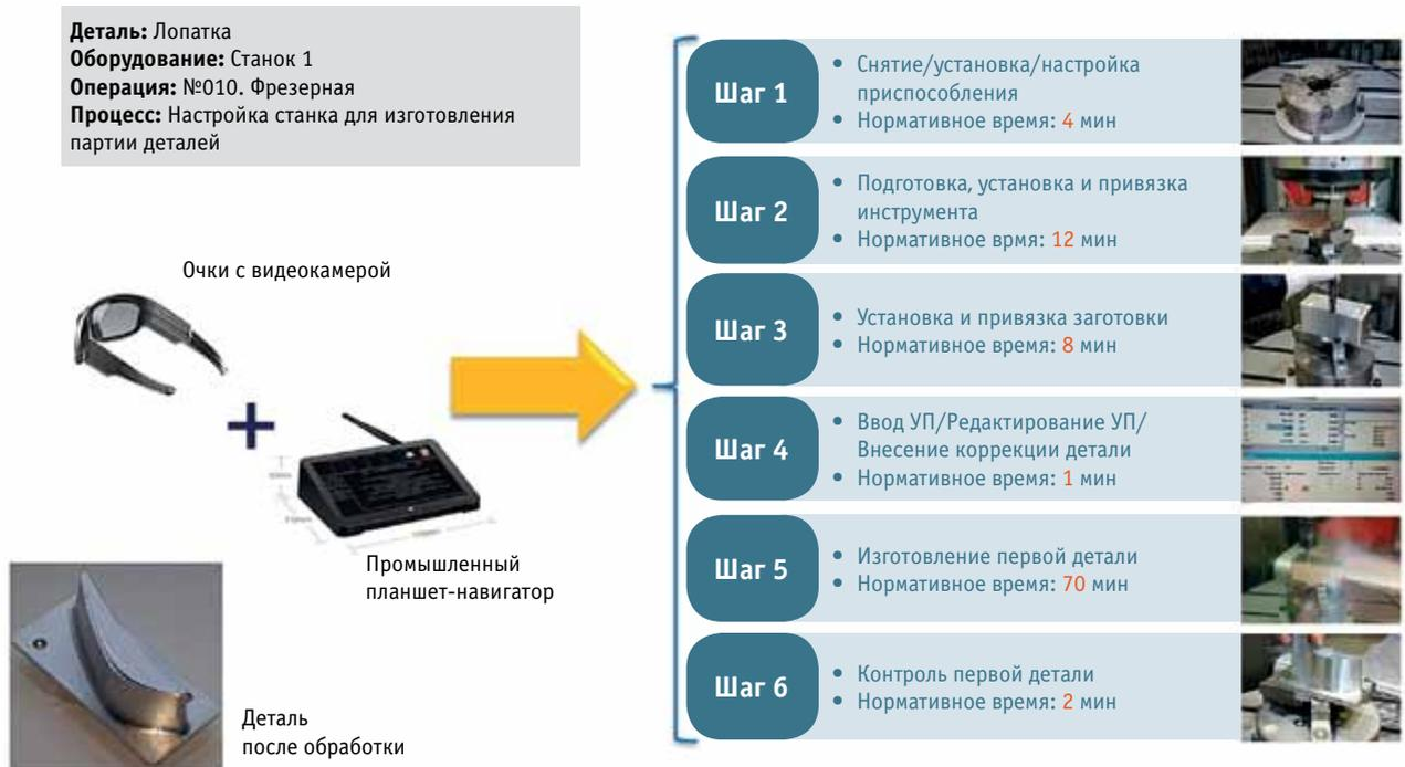
Рис. 8. Создание нормированного пошагового алгоритма технологической подготовки оборудования
