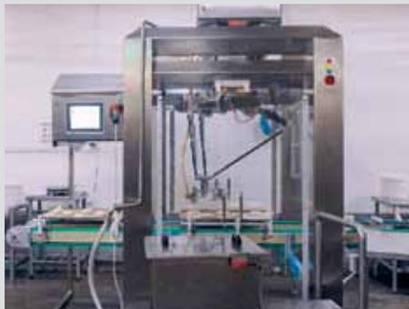
Основные операции, которые выполняет машина: трехмерное сканирование противня с тестовыми заготовками, выдавливание в них углублений, нанесение меланжа для образования румяной корочки и отсадка творога в полость.
