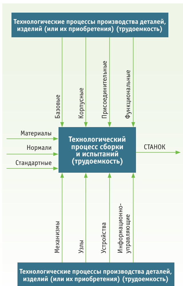
Рис. 4 Типовая схема сборки станка из его элементов
