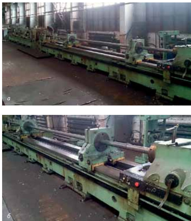
Рис. 1. Станок глубокого сверления РТ 263214: а – общий вид станка, б – узел стыковки частей станины
