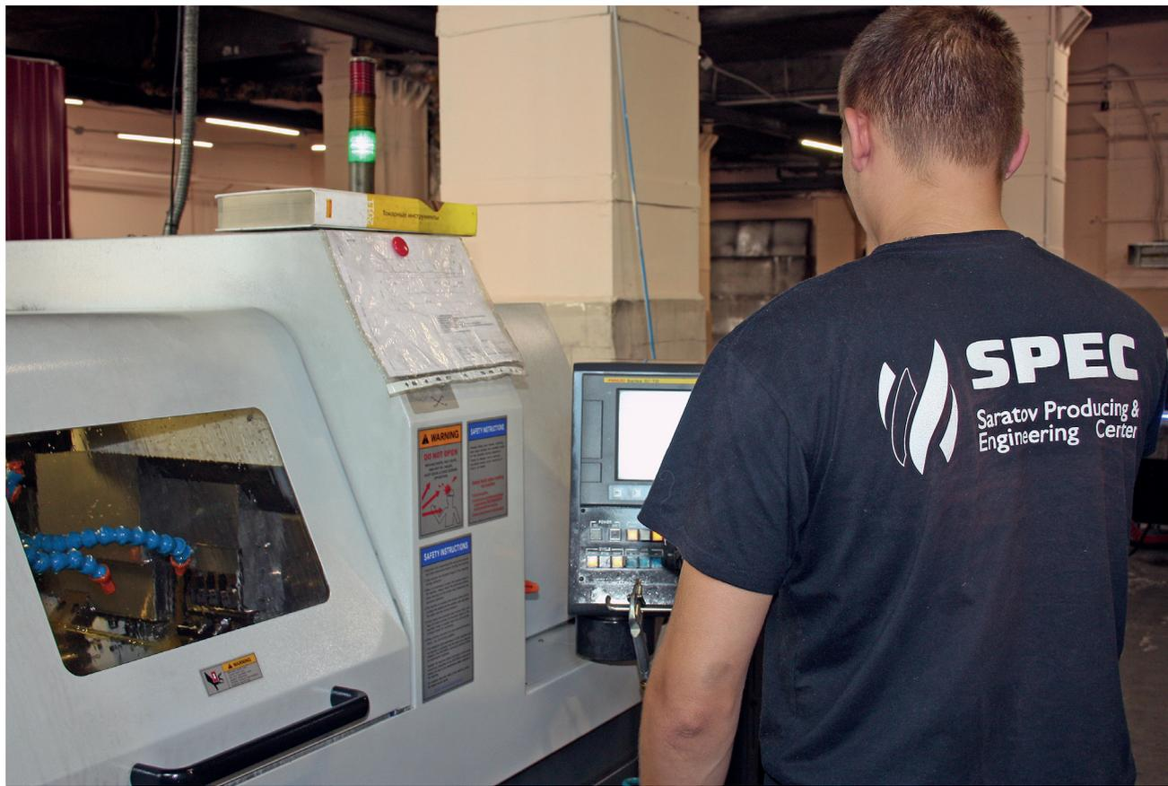
ку существенно быстрее, чем обычно, уменьшив при этом себестоимость изделия. Мы обрабатываем много титана, а при перекалке на нем образуется упрочненная корка, прежде чем ее удаление уходила большая часть времени. После перехода на CoroTurn 300 оно сократилось вдвое, а это, в свою очередь, значительно уменьшило расход инструмента.
