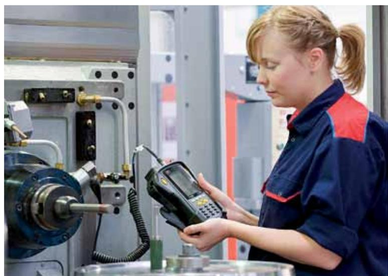
Рис. 2. Пусконаладочные работы и контроль параметров ШУ специалистом SKF
