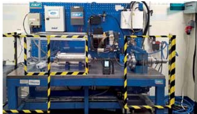
Рис. 3. Испытательный стенд SKF для обкатки ШУ
