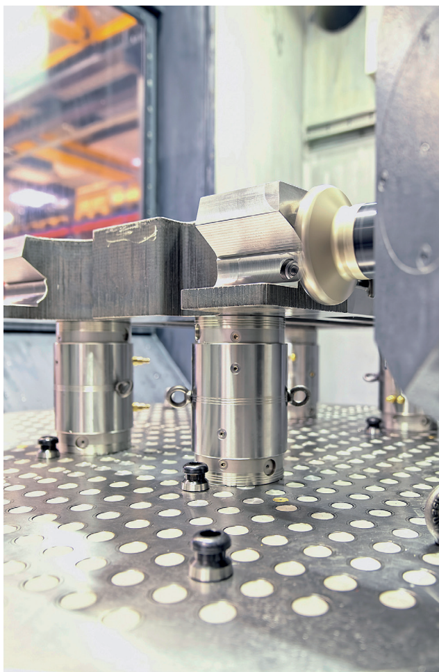
Рис. 5. Благодаря приподнятому положению обеспечивается свободный доступ переднего конца шпинделя с 5-ти сторон заготовки
