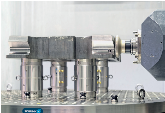
Рис. 4. Обработка при непосредственном зажиме. При разработке конструкции оснований для адаптеров, учитывалась возможность использования фиксирующих пальцев SCHUNK VERO-S. Зажим выполняется непосредственно на удлинителях высоты модуля VERO-S WSK plus
