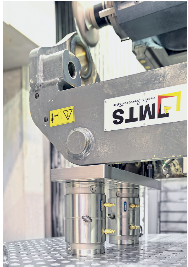
Рис. 8. Во время ремонта происходит фрезерование внутренней поверхности и сварочных швов. Шаг 50 мм базовой плиты и шаг 10 мм на пластине перекрывают все размеры от 150 до 1600 мм. Благодаря непосредственному зажиму обеспечивается свободный доступ к детали
