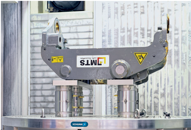
Рис. 7. Для ремонтных работ MTS использует непосредственный зажим в сочетании с призматическими кулачками. Зажимное устройство можно адаптировать к соответствующей заготовке с помощью сетки с отверстиями 10 мм
