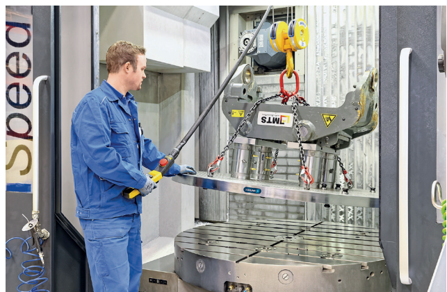
Рис. 9. Настройка зажимных паллет осуществляется в станке, во время основного технологического процесса обработки, а для смены паллет требуется выполнить всего несколько коротких операций
